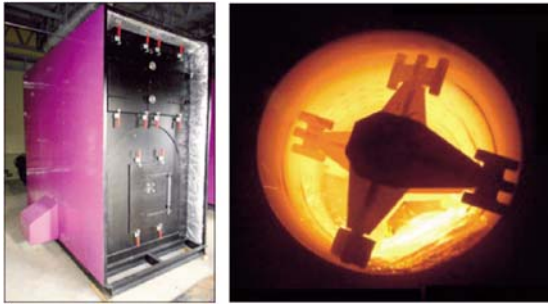
図11 開発したボイラと燃焼状態
