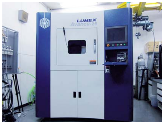
図1 金属粉末積層造形装置の外観 (株松浦機械製作所製 LUMEX Avance-25)
