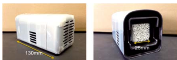
図1 吸着材コート基材の臭気ガス吸着試験用装置
