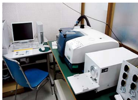
図2 THz帯FT-IR（日本分光製FT/IR6300FV）
