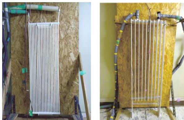
図3 放射パネルの外観（左：樹脂製、右：金属製）
