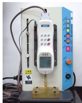
図6 抗折試験に用いた自動式荷重検出器
