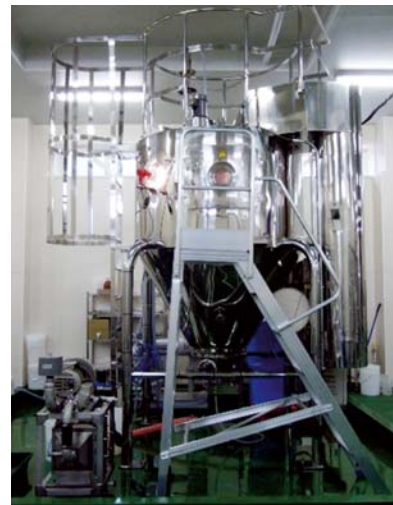
図10 スプレードライによる乾燥
