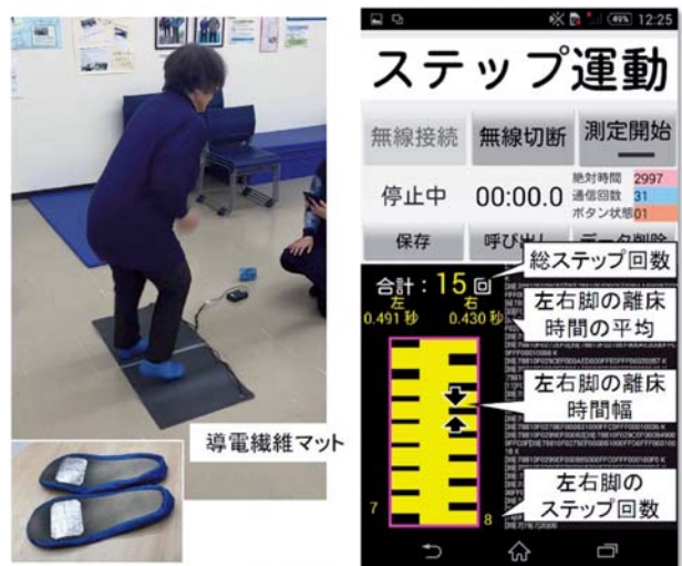
アルミテープを足カバー裏に貼付
