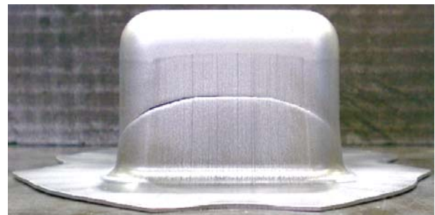
図 21 加工品（不良：亀裂）
