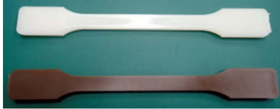
図2 ダンベル型試験片 上) PA6, 下) 10%CNF強化PA6
