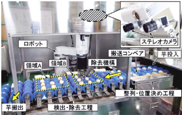
図 21 不用部除去システム（第一試作機）
