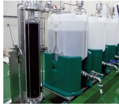
図9 実際の流通式脱色プロセスの写真
