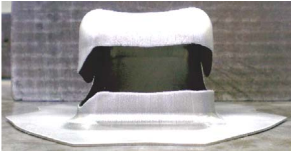
図 23 加工品（不良：割れ）
