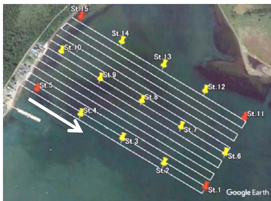
図7 設定した飛行経路
