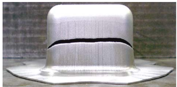
図 22 加工品 (不良: 小割れ)
