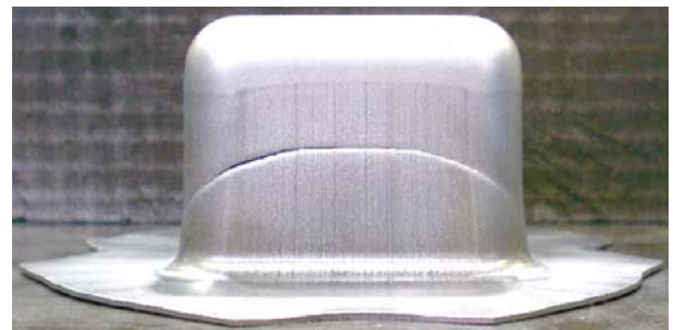
図 21 加工品 (不良: 亀裂)
