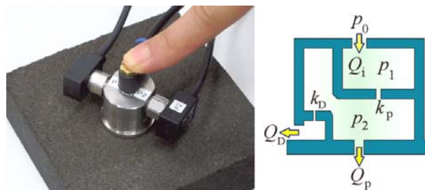
図8 通気抵抗計測プローブの外観と構造模式図
