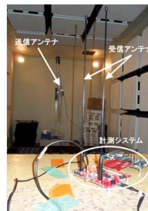
図21 電波暗室における計測試験
