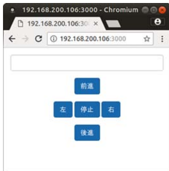
図14 インターネット経由での車両の制御画面
