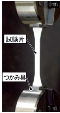
図6 引張特性試験（引張最大応力測定）
