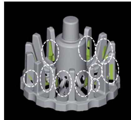
図11 初期の測定例と欠損状態（○印内が欠損部分）
