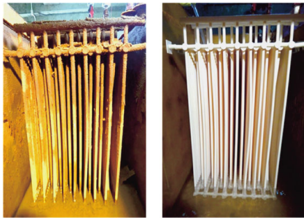
図18 濃塩酸水によるスケールの溶解
