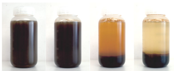
図4 処理水の凝集状態
