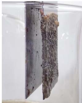
図6 陽極 (右側) への凝集物の付着
