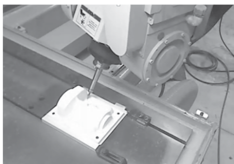
図 14 木型モデルの5軸切削加工の様子
