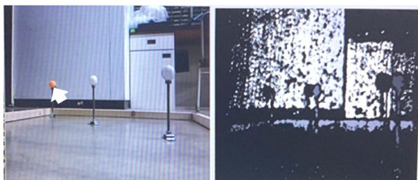
図9 センサ情報の補完指示 左：カーソルによる作業対象の指示， 右：センシング（R200）結果（距離画像）
