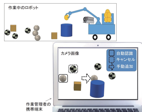
図1 センシング情報補完作業のイメージ
