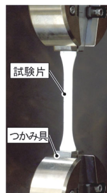
図8 引張特性試験（引張最大応力測定）
