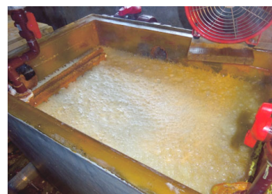
図17 濃塩酸に浸漬した熱交換器
