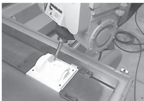
図 14 木型モデルの5軸切削加工の様子
