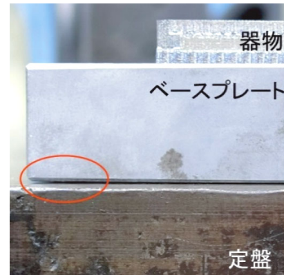
図15 修正2次元器物におけるベースプレートのそり
