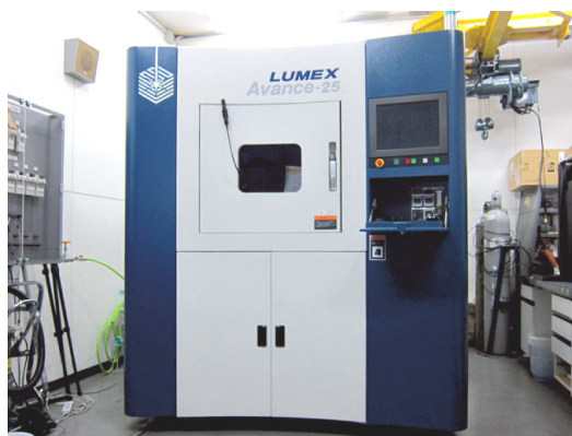
図1 金属粉末積層造形装置の外観 (株)松浦機械製作所製 LUMEX Avance-25
