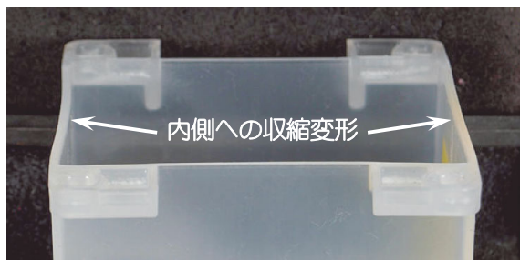
図 14 成形品に生じた収縮変形の例
