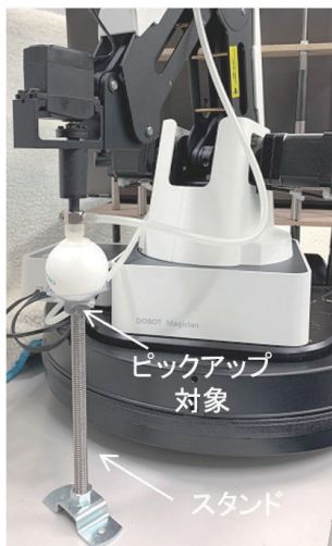
図7 機能試験の作業対象
