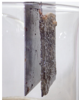
図6 陽極 (右側) への凝集物の付着
