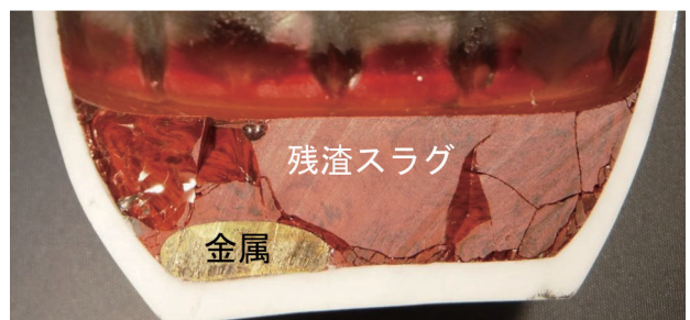
図5 基本原料に、貝がら25g、活性炭1.2g混合、熔融後の試料断面
