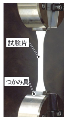
図8 引張特性試験（引張最大応力測定）
