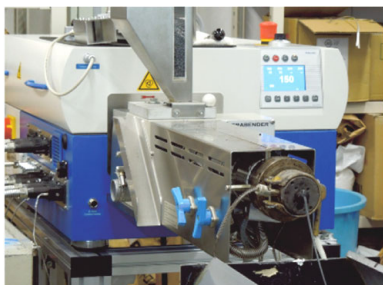
図2 押出機でのフィラメント材料の製作
