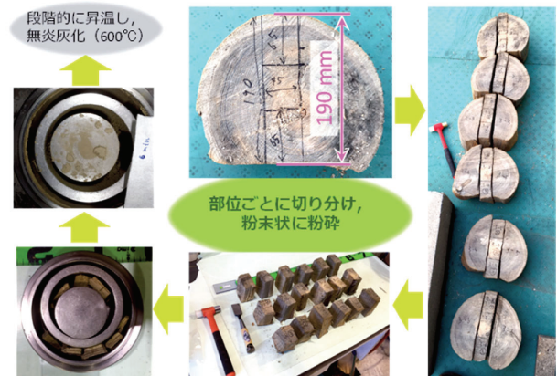
図6 採取した流木の切り分けと粉碎工程
