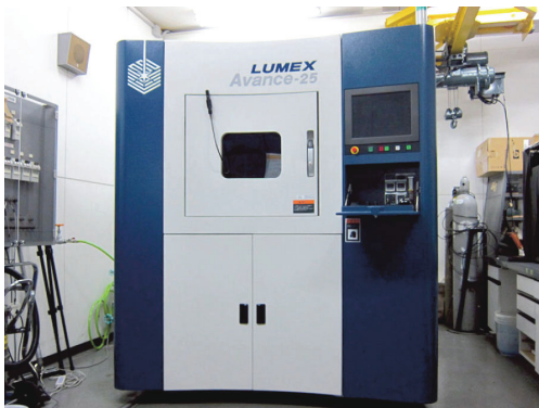
図3 金属粉末積層造形装置の外観 (㈱松浦機械製作所製 LUMEX Avance-25)
