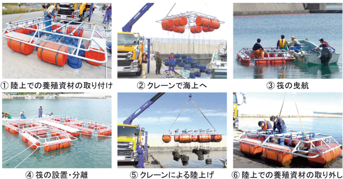
図 10 小型筏による作業試験の様子
