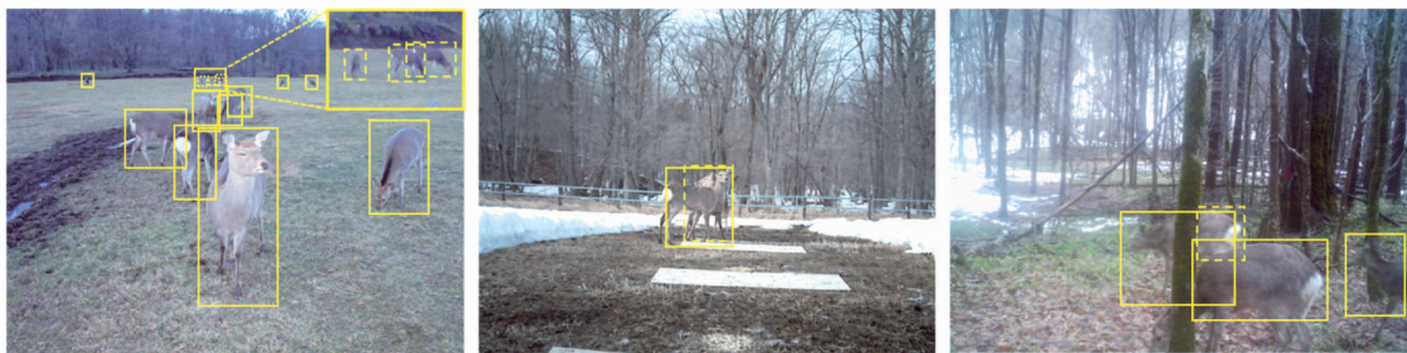
図8 エゾシカ検出失敗例 (破線枠：検出失敗, 実線枠：検出成功)
