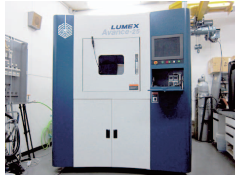
図2 金属粉末積層造形装置の外観 (株)松浦機械製作所製 LUMEX Avance-25)
