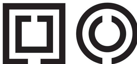
図1 メタマテリアルに用いられる導体形状の例
