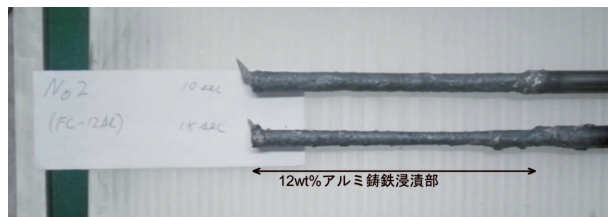
図 9 12wt%Al アルミ 鋳鉄に 10 ～ 15sec 浸漬した鋼材
