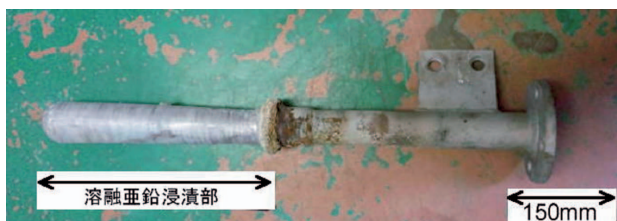
図2 操業炉で使用後の鋼製保護管
