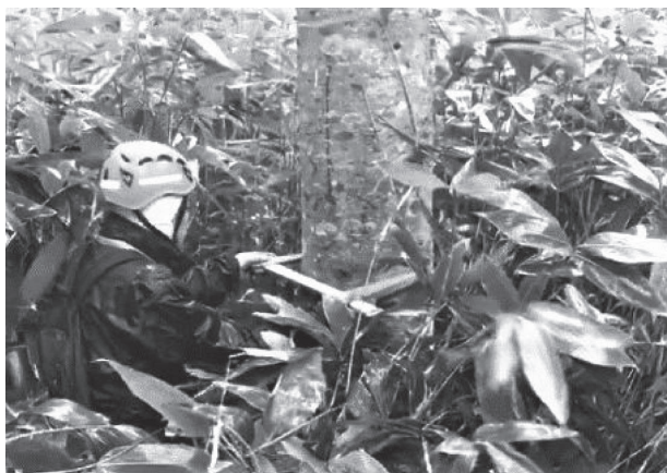
図1 輪尺により胸高直径を計測する様子
