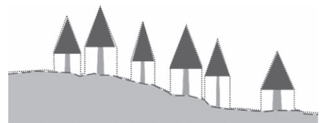
..... DSM (表層高データ、UAVで取得) --- DEM (地表高データ、国土地理院等) 樹高 = DSM - DEM
