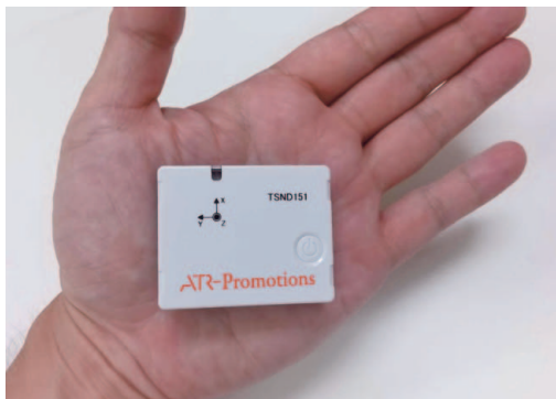
図4 計測に用いた慣性センサ (TSND151, ATR-Promotions製)
