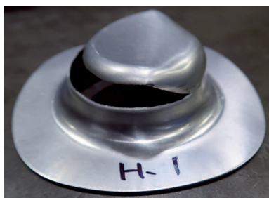
図 9 A5052P-H32 加工中期での割れ
