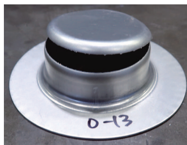
図 12 A5052P-O 加工終期での割れ
