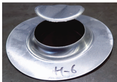
図 10 A5052P-H32 加工初期での割れ
