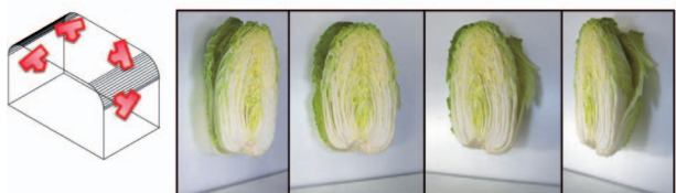
図4 カメラレイアウト：アーチ状の撮像例
