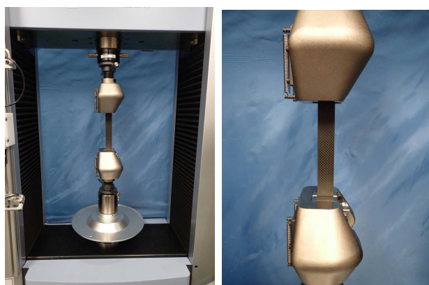
引張試験の様子（左：全体像、右：試験片拡大）
