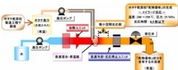
「乾物香味」製造マイクロ化学プロセスのスキーム
