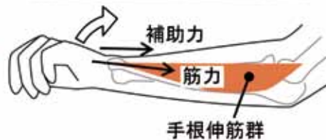
試作サポータの装着による筋負担の軽減
