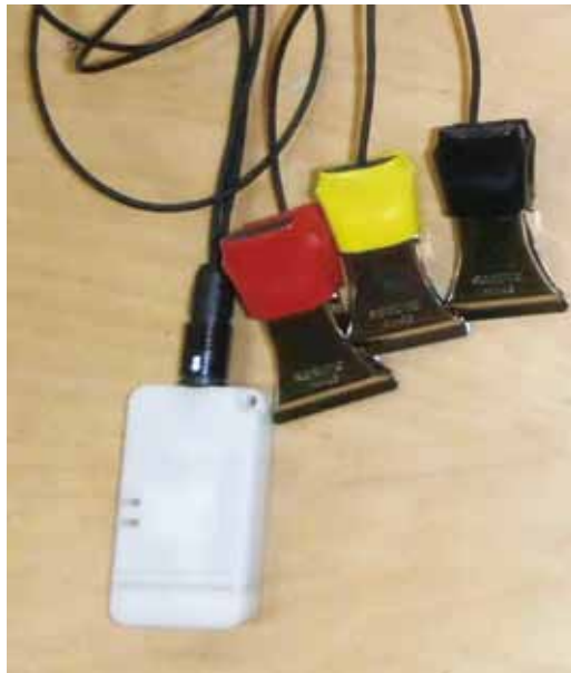
開発した乳牛用小型ワイヤレス心電計
