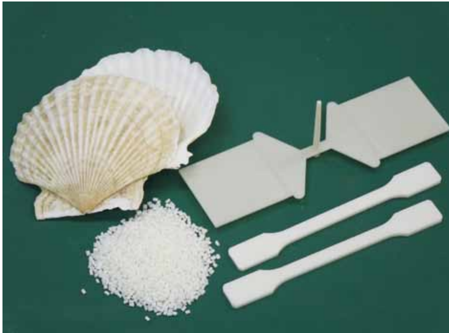
ホタテ貝殻を利用したプラスチック複合材料と成形体
