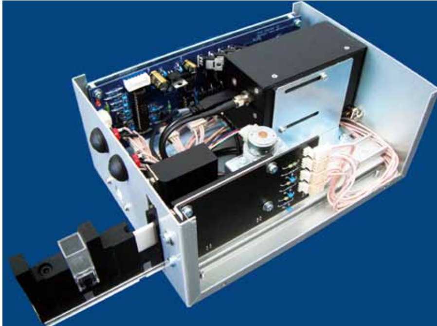
試作した生乳検査装置の外観
