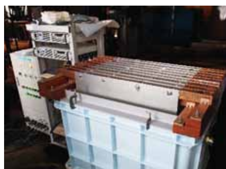
カドミウム除去実証試験装置
