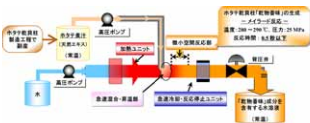
「乾物香味」製造マイクロ化学プロセスのスキーム
