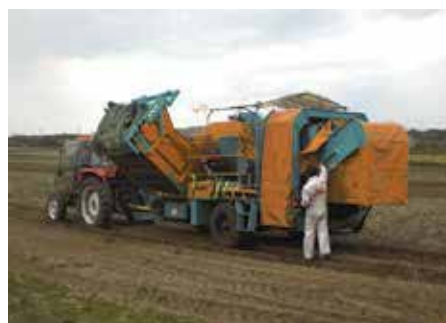
掘取り作業時の油圧負荷計測
