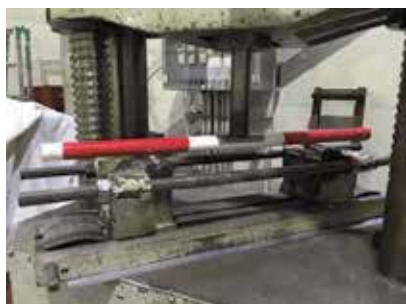
図1 路端標示柱に適用した強度試験
