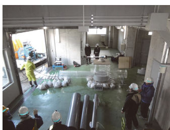
模擬下水道管路を用いた推進制御試験 (左：試験状況全景、右：ロボットの推進状況)
