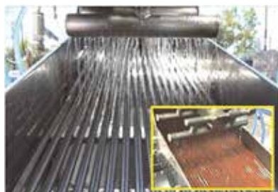
洗浄液供給部：多孔式シャワーヘッドにより卵への衝撃力を低減
