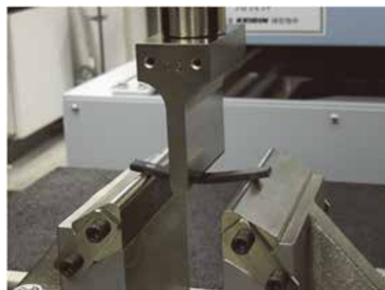
再生プラスチック材料の曲げ特性評価
