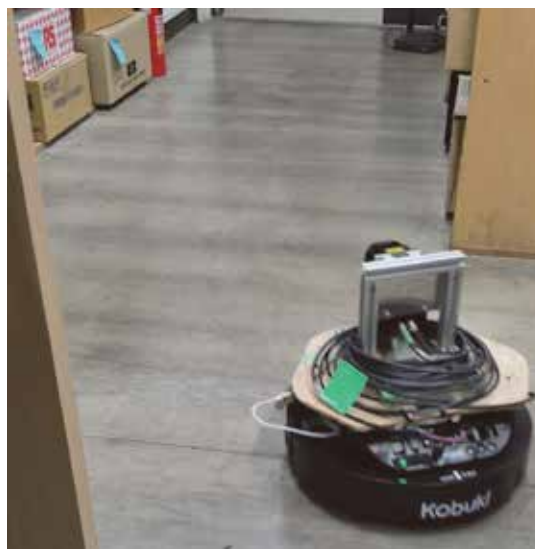
自律移動で目標地点に接近する移動台車
