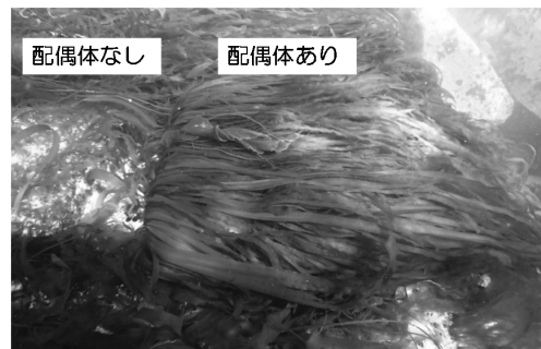
図11 試験用コンクリート基質上のコンブ生育状況(囲いブロック上の一例)
