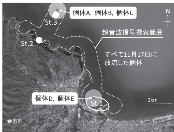
図12 第4回(11月18日実施)超音波信号探索結果 図中、二重同心円のうち、小さい円は信号受信位置、大きい円は信号受信可能な範囲を示す。
