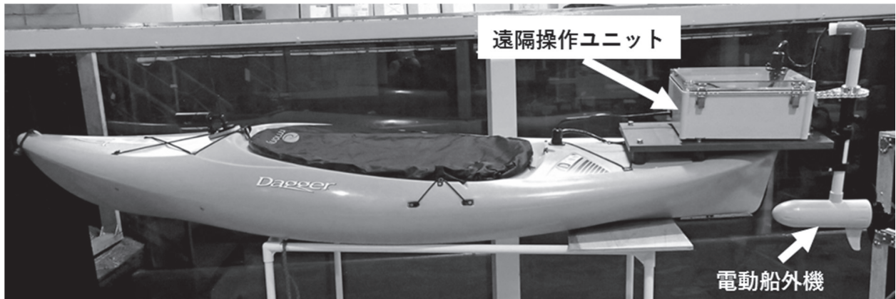
図 2 自走式調査装置
