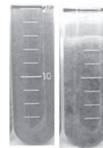
図 5 粉碎処理別ペーストの水分散安定性 (静置 7 日)
