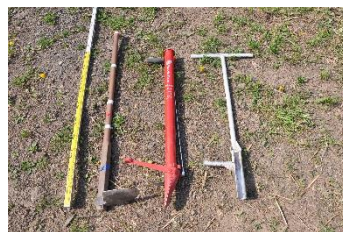
図3-8 コンテナ苗植栽器具 左から島田グワ、プランティングチューブ、ディプル(円筒型)
