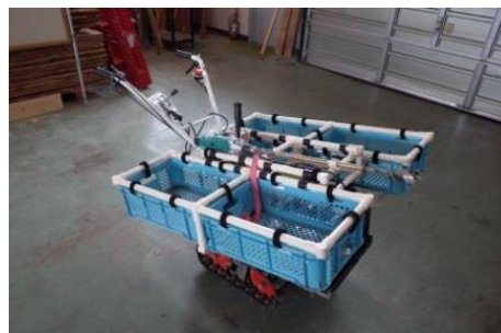
図4-5 改良した小型運搬機 コンテナ容器を4つ積むことができる
