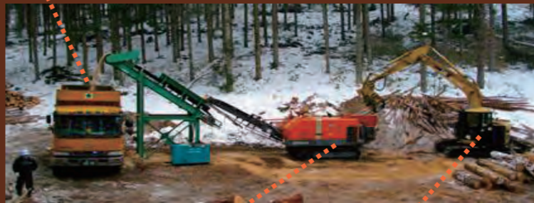
土場にチップパーを持ち込んでチップ化 森林バイオマスを投入
