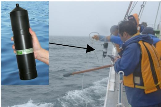
図1-1. 超音波受信機の設置
