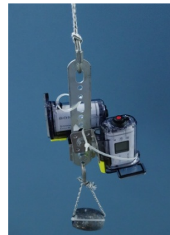
写真1: 簡易撮影装置 (重量2kg程度)
