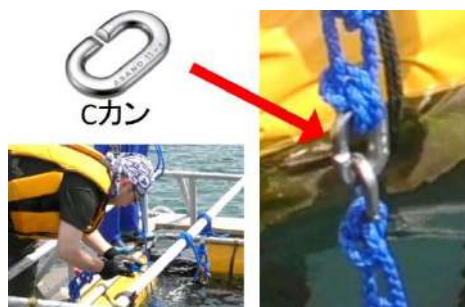
図 4-1-13 Cカンによるロープの締結
