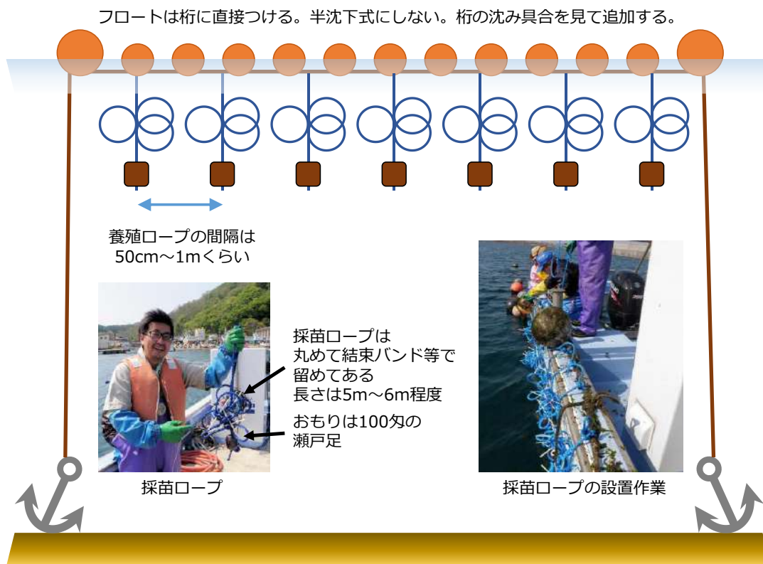
図4-4-3 余市港のムラサキガイ養殖桁と天然採苗器の設置方法
