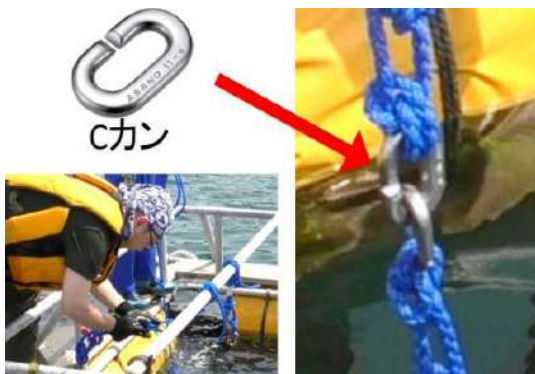
Cカンを用いた養殖かごの結束作業 結束時間が約1/10になり、作業が 楽になる。
