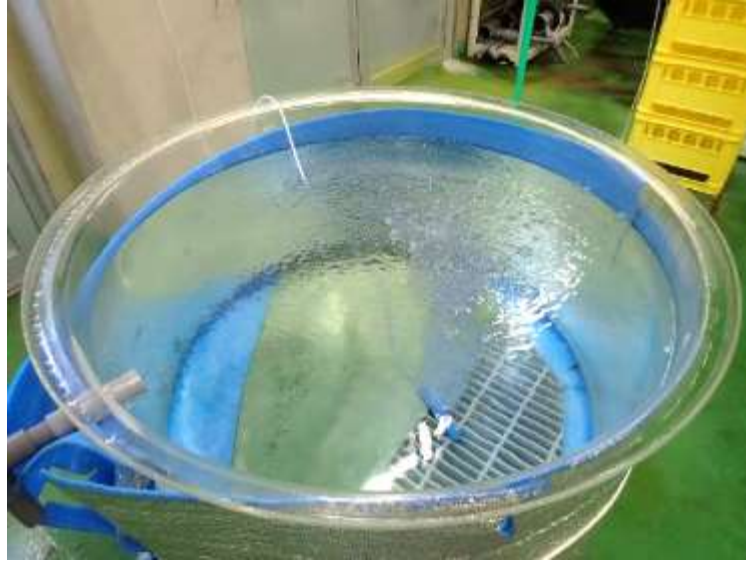
図 7. 吐出量 7L/min のエアポンプで 500L ポリカーボネートタンクに通気した状態 観賞魚用のエアポンプの強力なものに相当するが、500L タンクに通気すると「やや強い」程度となる。
