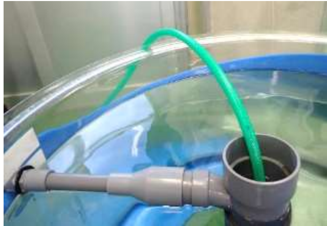
図 22.排水パイプの内側からホースで排水している状態
