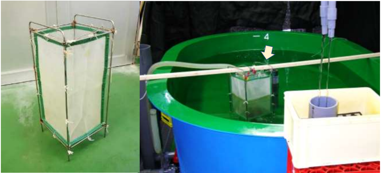
図 4. アンドンネット(左)とアンドンネットを使って排水部を設置した例(右) 任意の箇所に排水部を設置できる。
