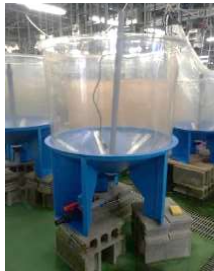
図 26. 市販されている容量 500L のアルテミア孵化槽
