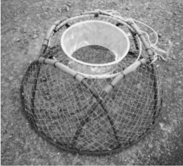
図1 調査に用いたかご かご枠：下枠径90cm, 上枠径32cm, 高さ40cm ろ斗：上口径32cm, 下口径26cm, 高さ15cm
