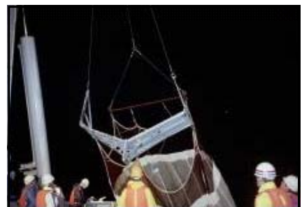
図2 アイザック・キッド式中層トロール(IKMT)による仔稚魚採集
