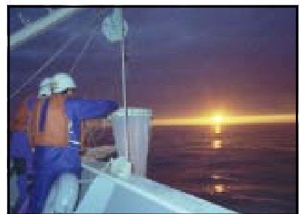
図1 プランクトンネット(ノルパックネット)による卵およびプランクトンネットの採集
