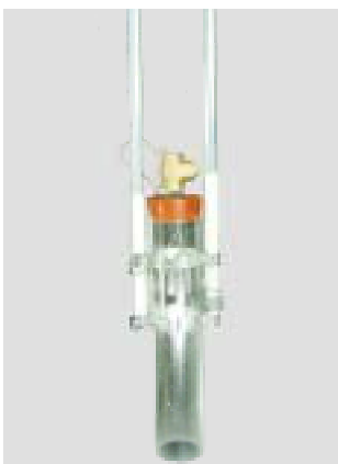
写真1 作成した採泥器
