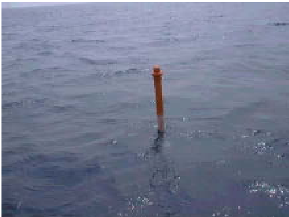
(写真3) 海上の通信ユニット部。約2m海面に出ている。
