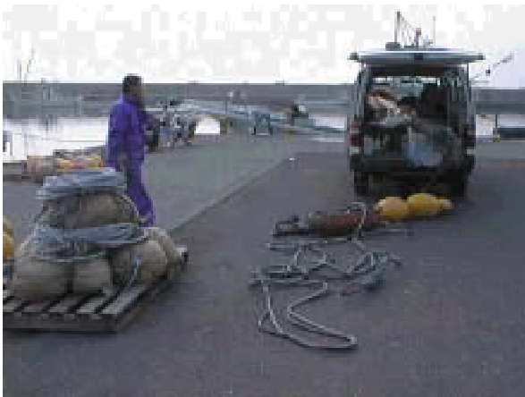
(写真1) ブイ全体 車の荷台にあるのが通信ユニット部、次いで浮子部、バッテリー部が続く。左にあるのはアンカー用の土嚢。小樽市祝津漁港にて。
